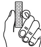
Для выхода из режима «привязки» кратковременно нажмите сервисную кнопку, сжав корпус блока пальцами
